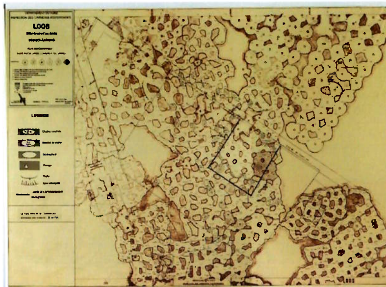
Exploitation de type chambres et piliers – SDICS
